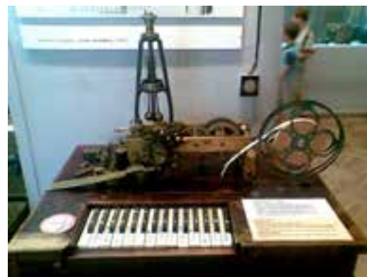
El telégrafo Hughes, uno de los modelos más avanzados de comienzos del siglo XX y con el que los hermanos Úriz Pi consiguieron premios internacionales.
